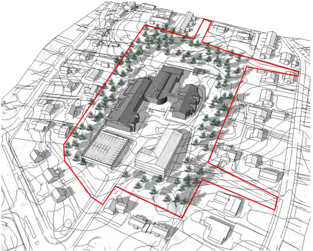
Havainnekuva asemakaavaluonnoksen mahdollistamasta toteutuksesta. Pysäköintipaikat on sijoitettu kahteen tasoon, mikä edellyttää tontin laajentamista puisto- ja katualueelle. Uudisrakennus on sijoitettu lähelle tontinrajaa. Järvenpään kaupunki, Kaavoitus ja liikenne 2017.
